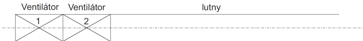
Obr. 12 Schéma sériové zapojení dvou ventilátorů
