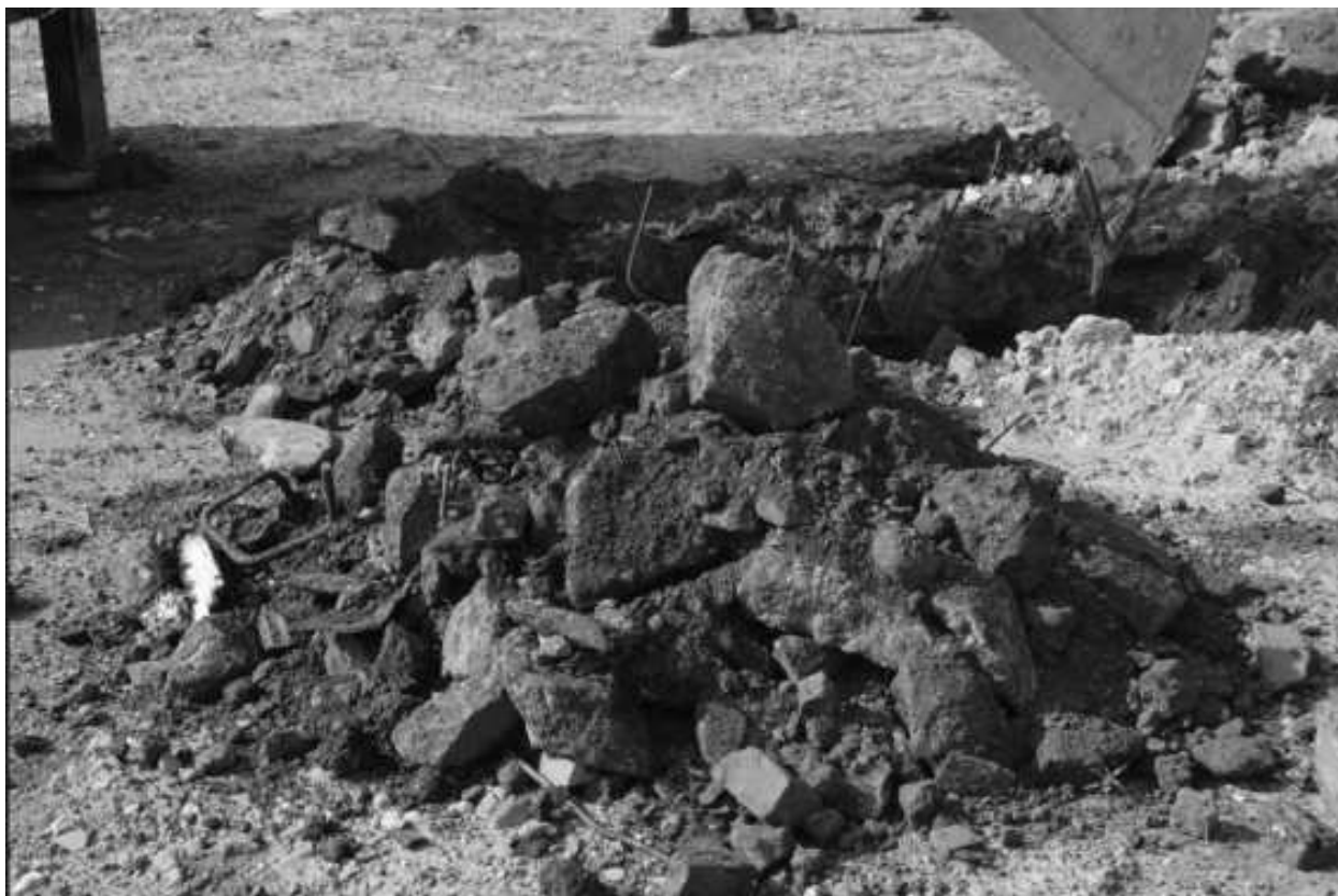
Sonda 5 – výkop obsahuje m.j. kusy dřeva, dráty, cihlové zdivo, střešní tašky
