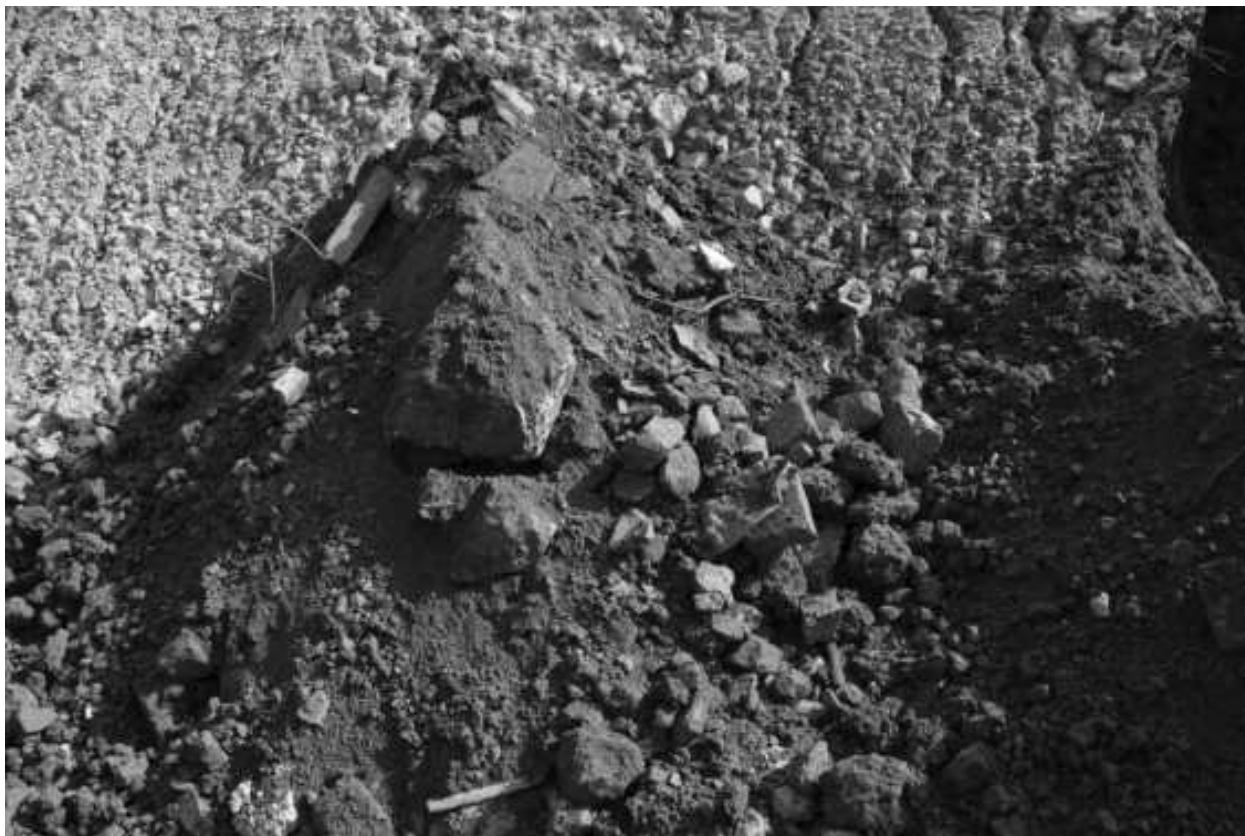
Sonda 3 – výkop obsahuje m.j. kusy cihelného zdiva, dráty, plasty
