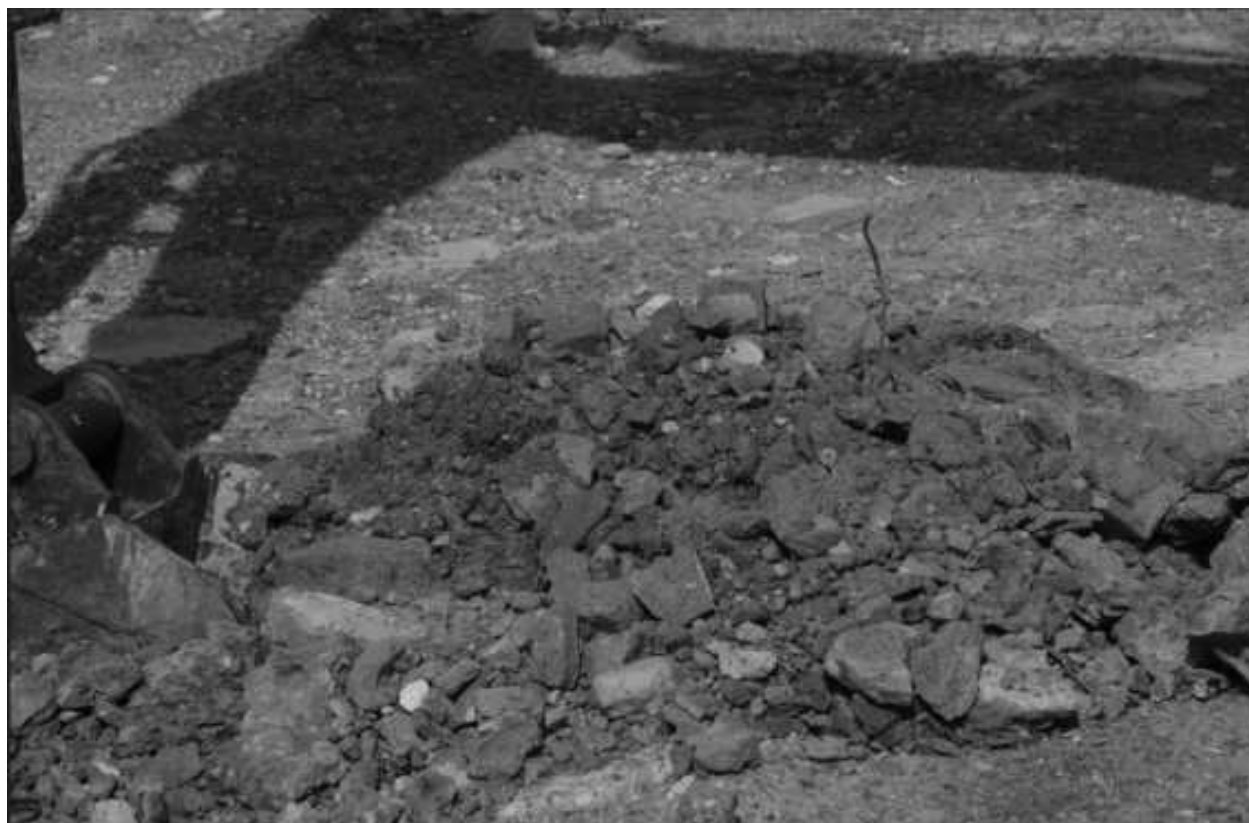
Sonda 4 – výkop obsahuje m.j. kusy cihelného zdiva, dráty, kořeny stromů
